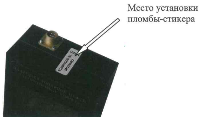
Рисунок 2 - Место пломбирования влагомеров нефти лабораторных УДВН-1л
