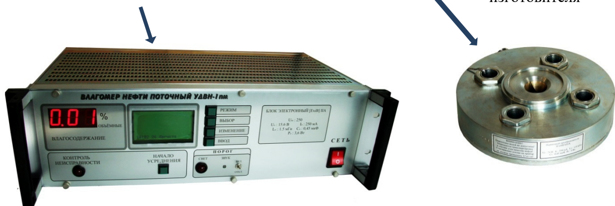
Рисунок 1 – Общий вид влагомера нефти поточного УДВН-1пм
