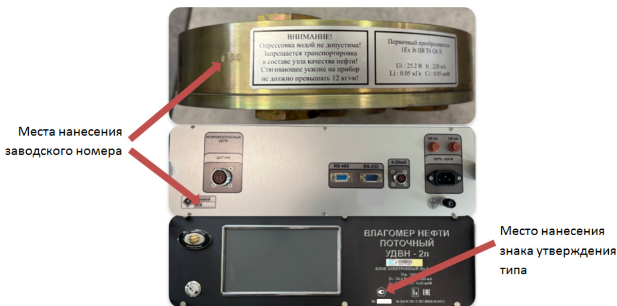
Рисунок 2 – Места нанесения заводского номера и знака утверждения типа влагомеров нефти поточных УДВН-2п
